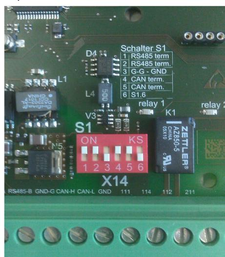
Рис. 9: Выключатель DIL S1
